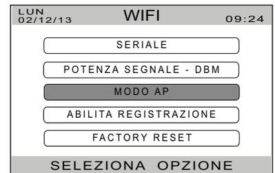
Sulla pagina principale del controllo remoto si visualizza la sigla AP per indicare l'attivazione della procedura. Il MODO AP ha un limite temporale di attivazione, superato il quale, nel caso in cui la procedura non vada a buon fine, il controllo remoto tornerà al normale funzionamento.
