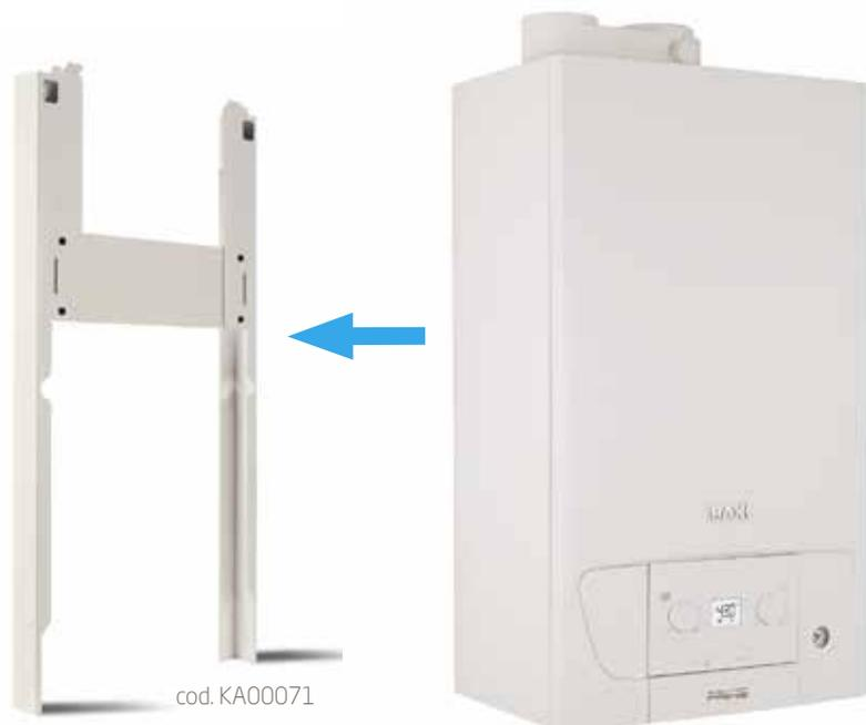
Il **telaio distanziale** permette di allontanare la **caldaia dal muro di 40 mm** consentendo il passaggio delle tubazioni nella parte posteriore dello schienale. Questo accessorio **facilita la sostituzione** della caldaia **eliminando i lavori di muratura**.
