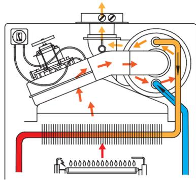
Lo scambiatore-recuperatore, posizionato all'interno della caldaia in alto a destra, è direttamente collegato al ventilatore che spinge i fumi al suo interno, dove condensano a contatto con l'acqua di ritorno dell'impianto, prima di venire espulsi. Il ventilatore modulante, ottimizza l'efficienza e il rendimento della caldaia.
