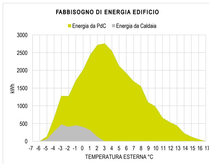
10% caldaia, 90% pompa di calore
