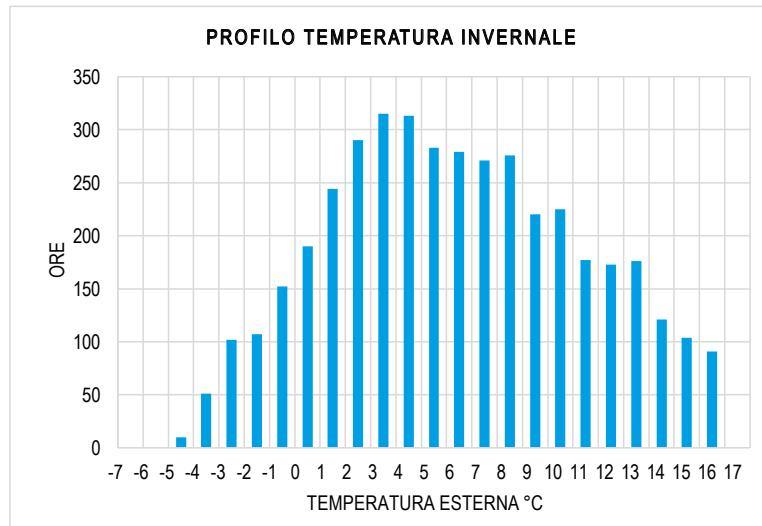
A causa del numero ridotto di ore che si hanno in corrispondenza di bassi valori di temperatura dell'aria esterna per la località esaminata, l'energia richiesta alla caldaia a condensazione risulta molto inferiore rispetto a quella che viene resa dalla pompa di calore. L'efficienza stagionale del sistema ibrido non ne risulta pertanto compromessa.
