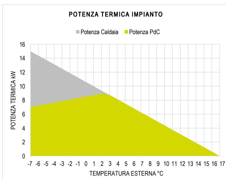
L'esempio riporta il caso di un edificio con un profilo di temperature invernali tipiche della pianura padana.
