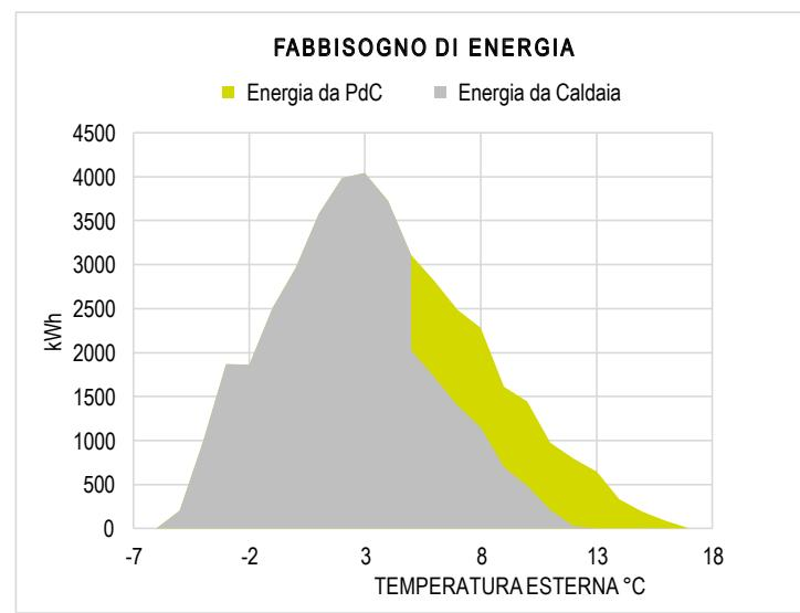
80% caldaia, 20% pompa di calore
