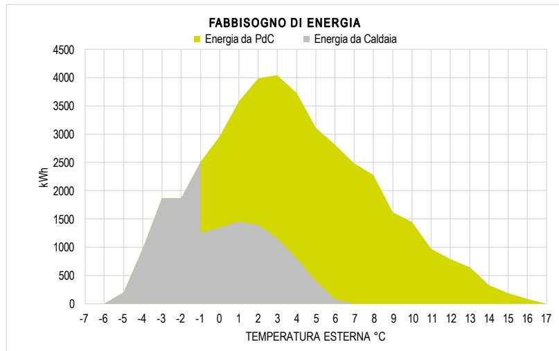
35% caldaia, 65% pompa di calore
