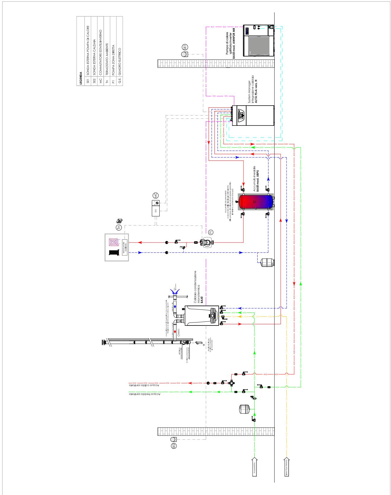
Pompa di calore spilitata Alya FS-A per riscaldamento/raffrescamento impianto con unica zona diretta e caldaia istantanea in integrazione nel periodo di riscaldamento, separazione idraulica con puffer e kit valvola solare. Produzione ACS su bollitore a singola serpentina integrato nel System Manager con integrazione della caldaia.
