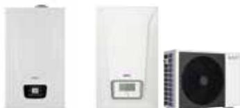
I sistemi Baxi Hybrid WH-A/FS-A si compongono di una pompa di calore aria-acqua splittata inverter murale (WH-A) o a basemento (FS-A) da 4 a 16 kW abbinata a varie tipologie di caldaie a gas murali a condensazione da 12 a 35 kW e sono gestiti da un Hybrid Connection per ottenere prestazioni elevate e la maggiore efficienza possibile sia in ambito riscaldamento/raffrescamento che nella produzione di acqua calda sanitaria.
